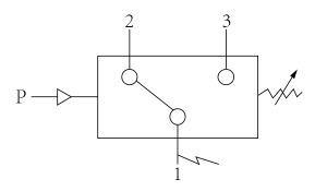
单刀双掷微动开关作用过程: 接线端 1-3 压力上升至上切换值接通;
