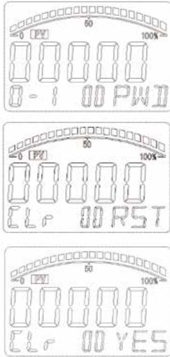
在正常工作状态下，长按“ZERO”按键3秒钟时间，液晶右下角显示PWD，提示输入密码，按S2输入密码1，液晶右下角提示NO、YES、RST三种状态，如果确认需要执行操作，选择YES，如果需要放弃操作，选择NO，如果需要复位之前的校准操作，选择RST，按S1、S2均可选择。确认操作按ZERO执行。之后变送器执行相关操作并返回到正常测量状态。
