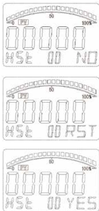
在正常工作状态下，长按“S2”按键3秒钟时间，液晶右下角显示PWD，提示输入密码，按S2输入密码1，液晶右下角提示NO、YES、RST三种状态，如果确认需要执行操作，选择YES，如果需要放弃操作，选择NO，如果需要复位之前的校准操作，选择RST、S1、S2均可选择。确认操作按ZERO执行。之后变送器执行相关操作并返回到正常测量状态。
