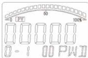
清零操作、零位校准和满度校准操作之前具有密码验证过程，此界面如作图所示。
