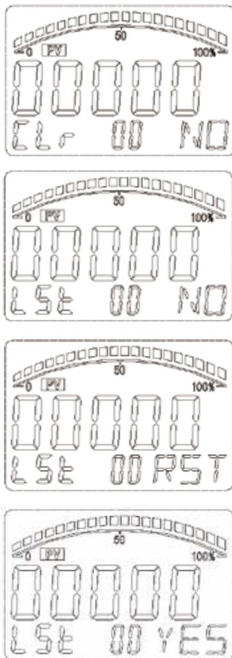
在正常工作状态下，长按“S1”按键3秒钟时间，液晶右下角显示PWD，提示输入密码，按S2输入密码1，液晶右下角提示NO、YES、RST三种状态，如果确认需要执行操作，选择YES，如果需要放弃操作，选择NO，如果需要复位之前的校准操作，选择RST、S1、S2均可选择。确认操作按ZERO执行。之后变送器执行相关操作并返回到正常测量状态。
