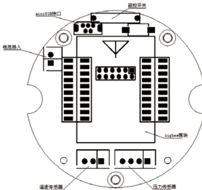
电源：使用锂电池供电，电源有反极性保护。
